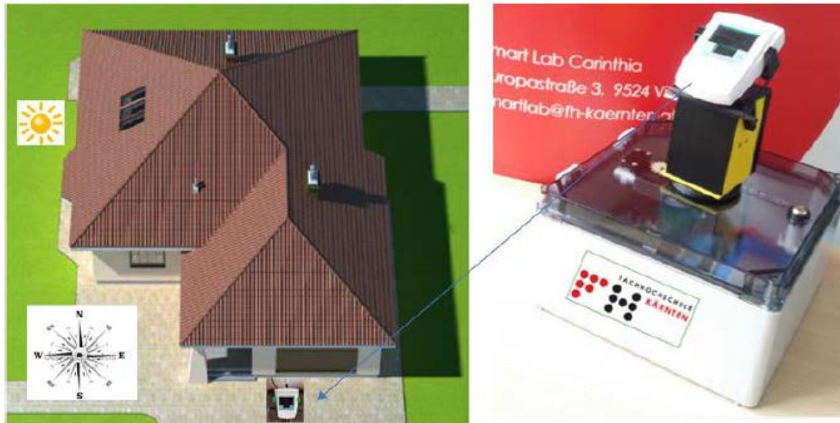
Abbildung 104 Solarsensor ist nach Süden orientiert
